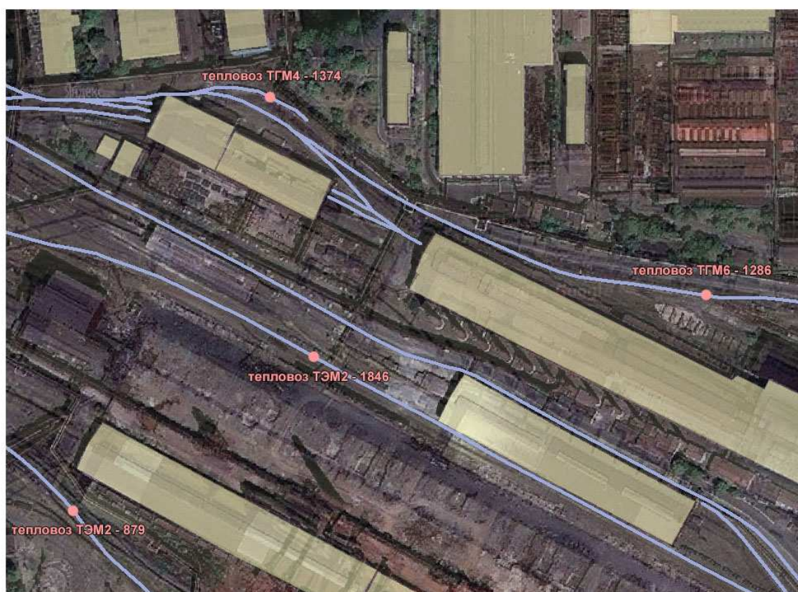
Рисунок 2 – Пример диспетчерского интерфейса
