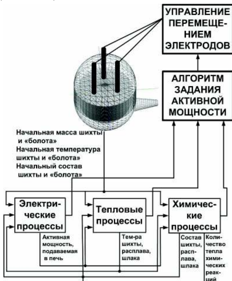
Рисунок 1 – Структура разработанной системы управления дуговой сталеплавильной печью
