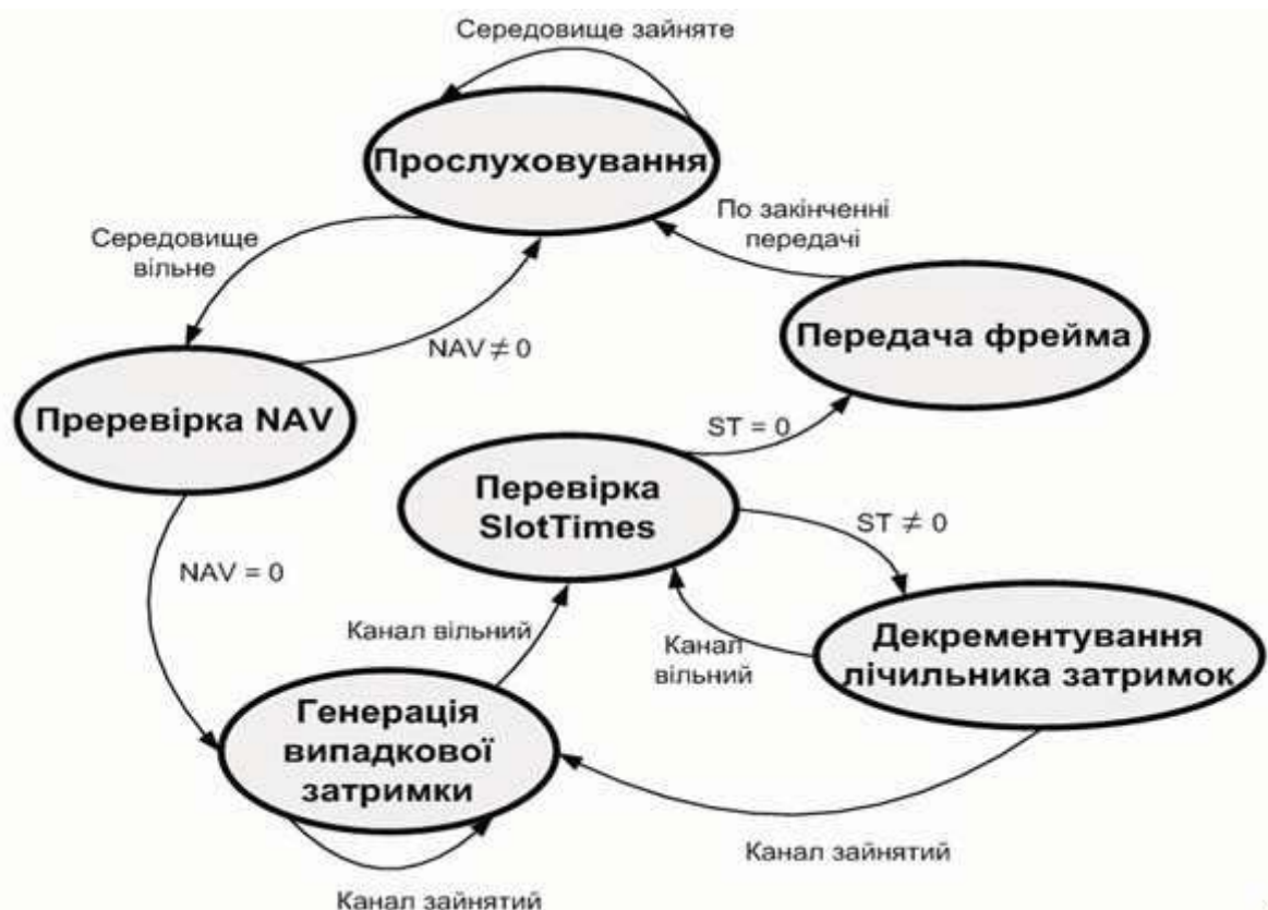
Рисунок 4 - Діаграма станів станції WLAN в режимі DCF
