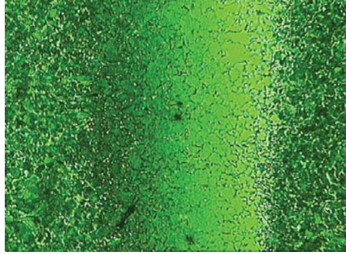
Рисунок 1 – Зразок №111 (пл. №42380), смуга мартенсіта
