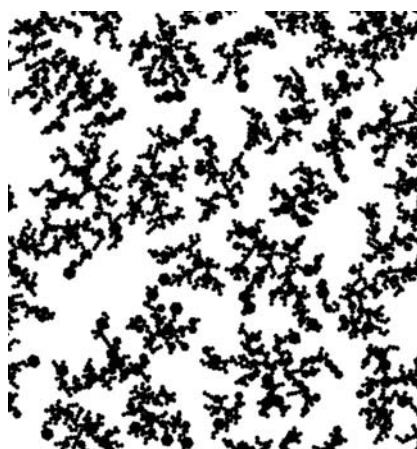
Рисунок 3 – Изображение функциональных покрытий в парофазной среде, полученных путем моделирования в программном продукте «Colcryst»
