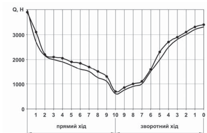
Рисунок 4 - Елемент осцилограм осьових сил при експериментальних дослідженнях, та результати розрахунків для маршруту 10,5Ч1,2→8,35Ч0,7 при відношенні довжин важелів OB/OA = 670/515
