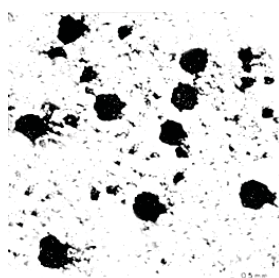
Рисунок 2 - Изображение коррозии поверхности нержавеющей стали AISI 304
