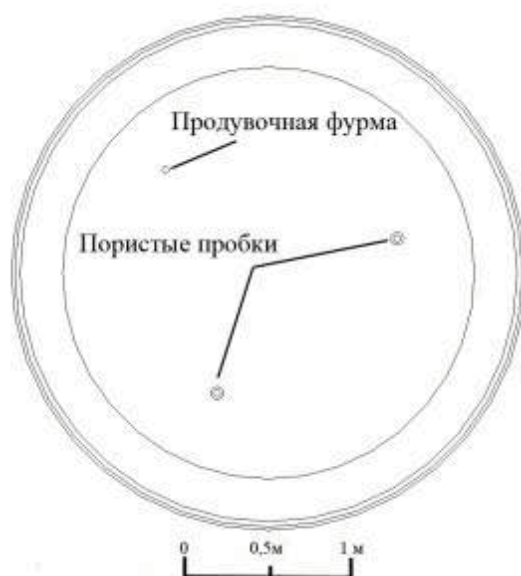
Рисунок 1 - Схема расположения погруженной фурмы и продувочных блоков в днище ковша
