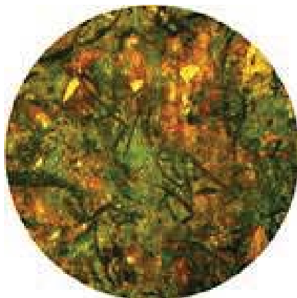
Рисунок 1 - Сірий чавун на перлітній металевій основі з фосфідною евтектикою
