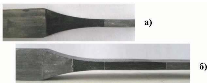
Рисунок 5 - Образцы в экспериментальных исследованиях перемещений объемов в очаге деформации: а) исходный образец, б) образец после прокатки
