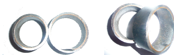
Рисунок 2 - Тимплеты прессованных биметаллических труб с некоторыми нарушениями сплошности биметаллического слоя
