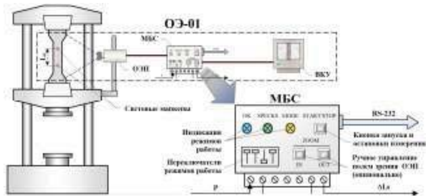
Рисунок 1 - Структурная схема оптоэкстензометра ОЭ-01
