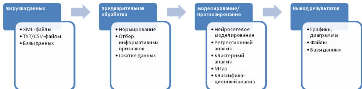
Рисунок 3 - Схема потока данных программного комплекса MiningLibs
