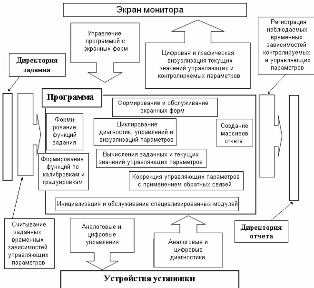
Рисунок 2 - Схема организации информационных потоков системы автоматического управления периферийными устройствами программно-аппаратного комплекса
