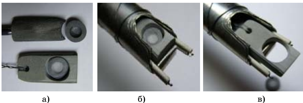
Рисунок 4 - Узел сбрасывателя подложки и образца ( а - толкатель до (вверху) и после (внизу) модернизации, положение тигля-подложки для образца до (б) и после (в) сбрасывания)
