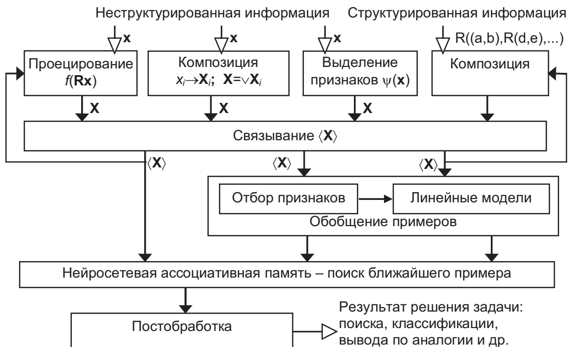
Рисунок 2 - Общая схема формирования и обработки распределенных представлений информации в рассуждениях по примерам
