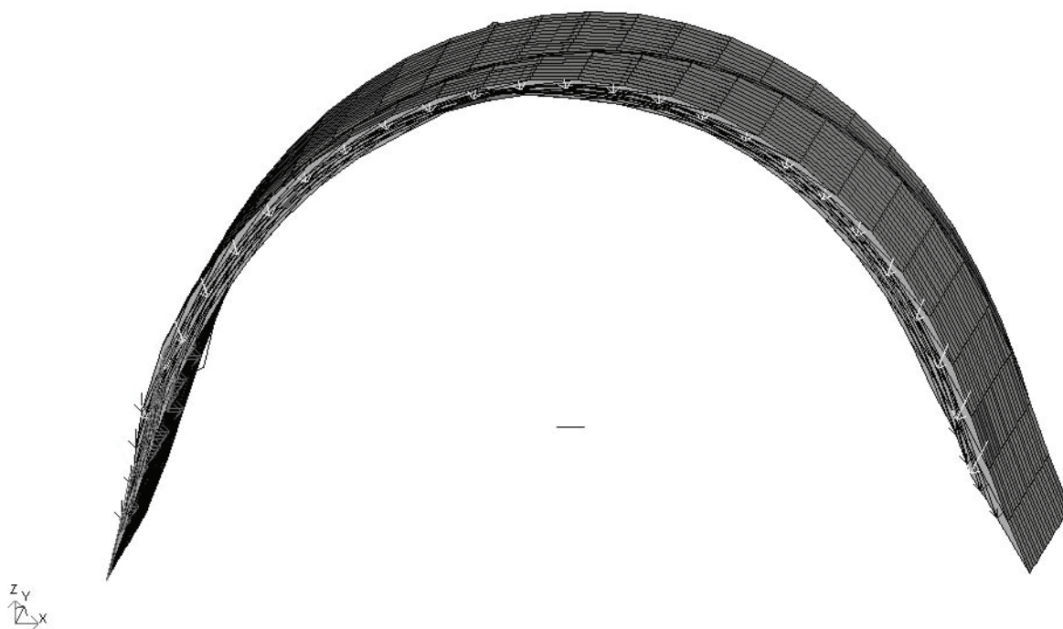
Рисунок 3 - Деформированная схема зубчатого соединения на приводном барабане
