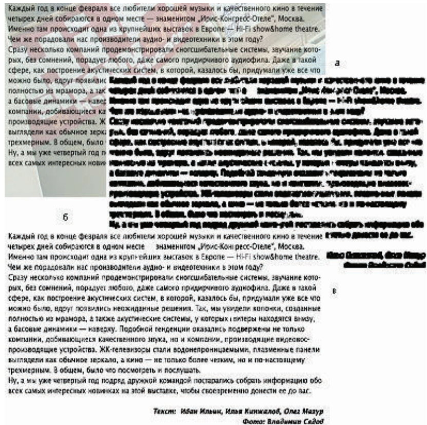
Рисунок 4 – а) оригинальный текст со сложным фоном; б) точки символа первого рода; в) точки символа второго рода
