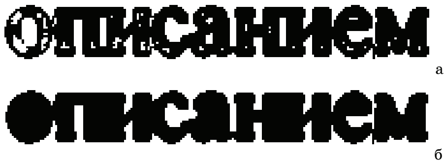
Рисунок 3 – а) пример связанного множества точек символа первого рода; б) пример примитива для связанного множества точек символа первого рода
