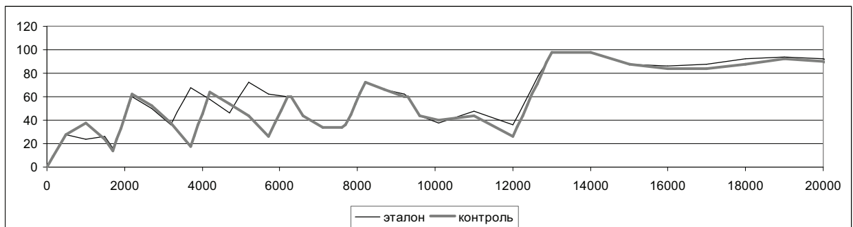
Рисунок 4 - Скорость эталонного и контрольного поезда на заданном перегоне
