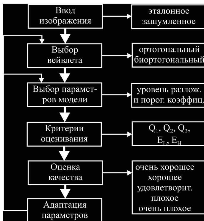
Рисунок 2 – Адаптивно–критериальная система создания модели вейвлет–фильтра изображений
