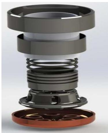
Рисунок 1 - Составляющие наконечника кислородно-конвертерной фурмы
