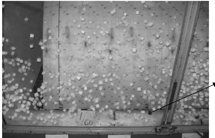
Рисунок 3 – Перемещение черного кубика (1) в фонтанирующем слое
